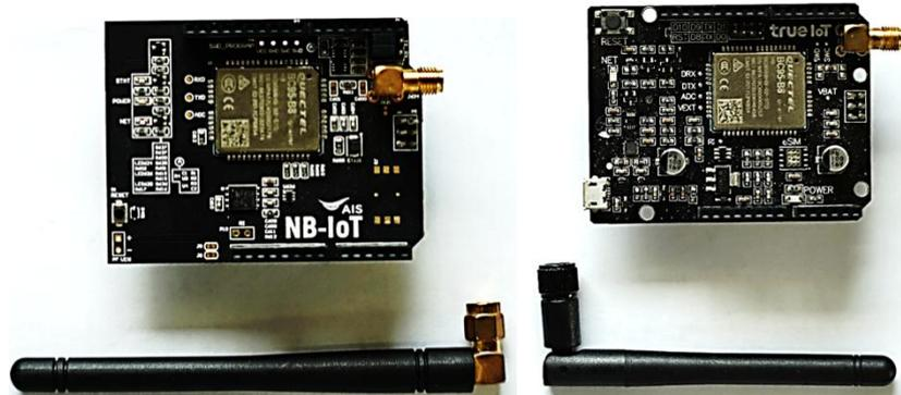
**Figure 2** AIS NB-IoT module and TRUE NB-IoT module
